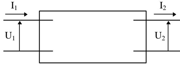
Le cadre contient un réseau électrique purement passif. Dans ce cas, les courants  $I_1$  et  $I_2$  dépendent linéairement de  $U_1$  et  $U_2$ . En effet, on peut les considérer comme les courants de mailles extérieures de sorte que l'on a :
