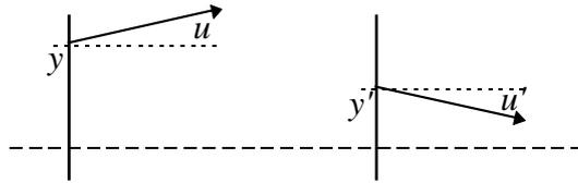
Entre deux points, on a en première approximation une transformation linéaire de  $(y,u)$  en  $(y',u')$  due à la présence d'appareils optiques tels qu'un système de lentille. Cette approximation est obtenue en confondant  $u$ ,  $\sin(u)$  et  $\tan(u)$  (autrement dit, on considère que la direction du rayon lumineux est très proche de celle de l'axe [approximation de Gauss]). La matrice de cette transformation est dite matrice de transfert. Par exemple, les matrices sont :
